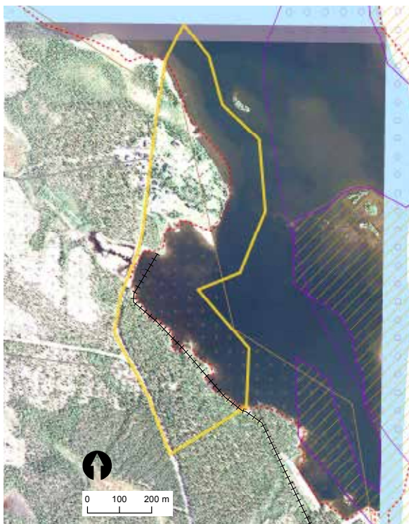
J5. Östansjö Beräknat 100-årsflöde markerad med röd linje Högspänningsledning är markerad med svart linje
