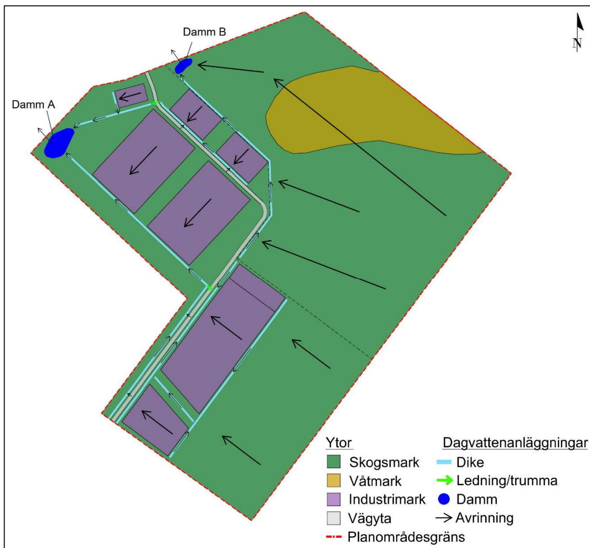
Figur 8. Föreslagen systemlösning för dagvattenhantering inom planområdet. Den svarta streckade linjen skiljer delen som avrinner mot damm A respektive damm B.
